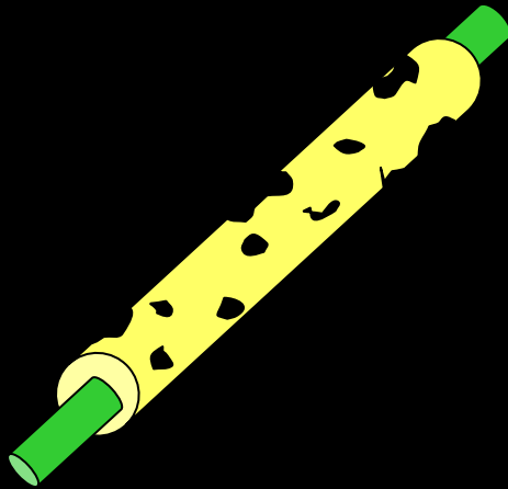
Dégradation de la partie résineuse
